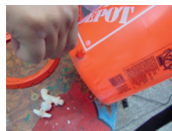
Imagen 2. Perfora para colocar llave y aros.
