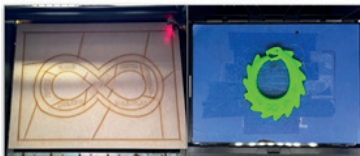
Figura 3. Corte láser del rompecabezas e impresión 3D.
