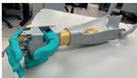
Figura 8. Diseño del primer prototipo de prótesis transhumeral.
