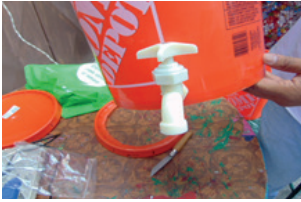
Imagen 3. Resultado de colocación de llave de drenaje.
