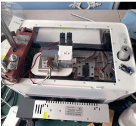
Figura 6. Fotografía de la máquina para deshacer el PET en hilo.
