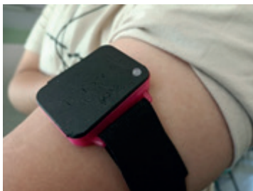
Figura 3. Pulsera medidora de temperatura basal, presión arterial y frecuencia cardíaca.
