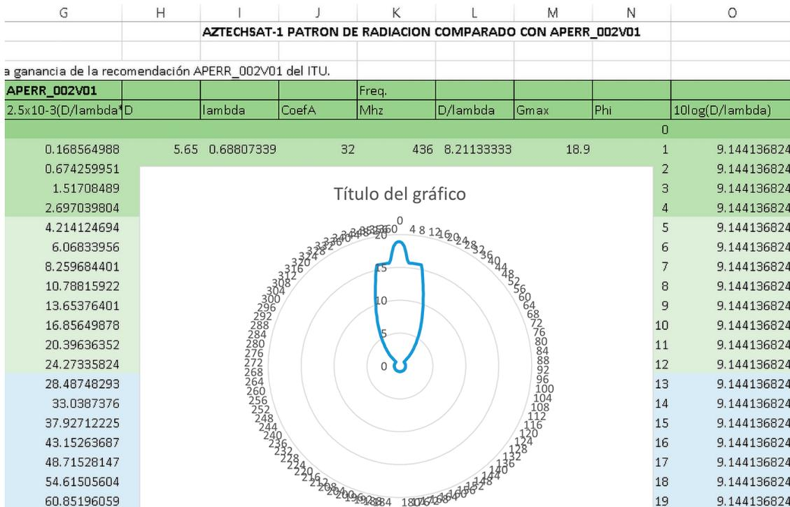
Figura 5.4.3.2: Patrón de Radiación de ITU Excel APERR002\_V1
